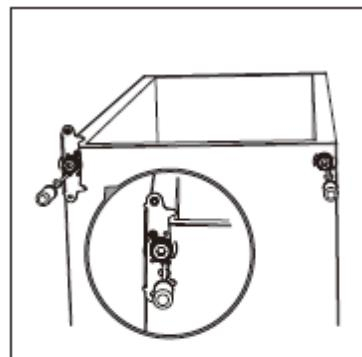
7. Встановіть дверцята на місце. Перед остаточним закручуванням верхнього шарніра переконайтесь, що дверцята вирівняно по горизонталі та вертикалі так, що ущільнювач щільно прилягає з усіх боків.
